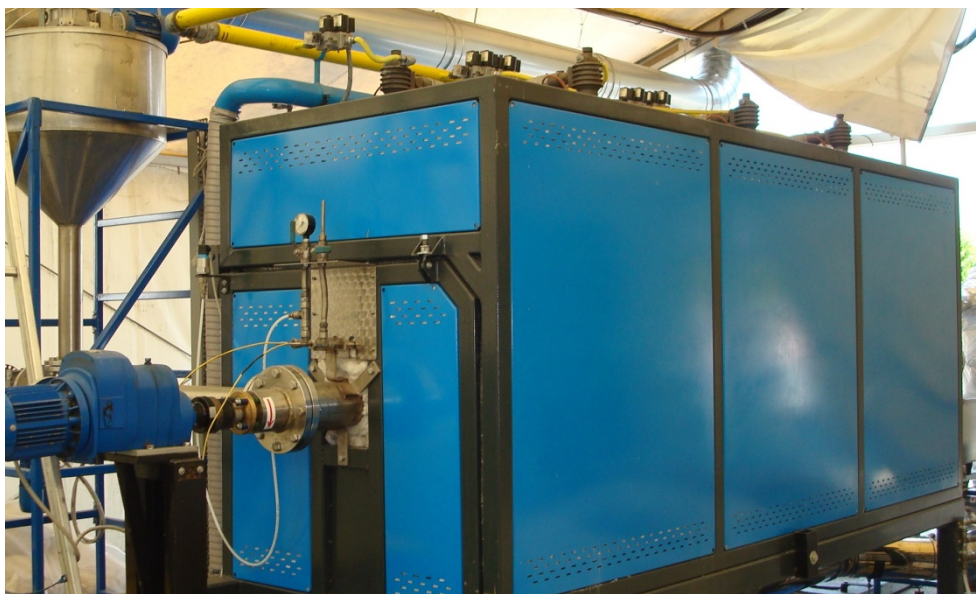
Modulo di pirolisi di portata 100 kg/h sviluppato nell'ambito del progetto CLEANGAS
